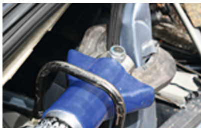
Hydraulische Schere im 90°-Winkel
