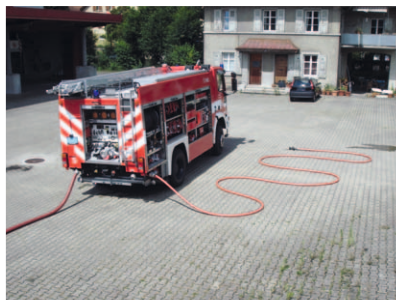
■ Beispiel mit Druckleitung direkt ab TLF
