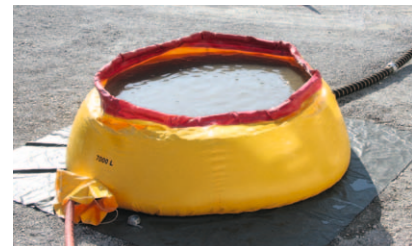
Ausgleichsbecken selbstaufrichtend, z.B. 7'000 l
