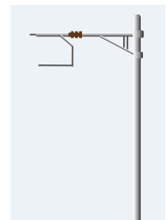
Fahrleitung, z.B. SBB 15 kV
